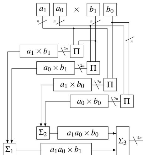
Nehmen Sie an dass die Bauteile  $\Sigma_1$ ,  $\Sigma_2$  und  $\Sigma_3$  mit Hilfe von Volladdierern gebaut sind, die jeweils aus 2 Und, 2 Oder und 2 Exklusive-Oder Bauteilen bestehen. Das Verschieben (bzw. Multiplizieren mit  $2^n$ ) der Operanden geschieht durch entsprechende Verdrahtung.
